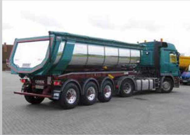
mit Edelstahl-Abdeckung bei gegenliegender Rückwand
