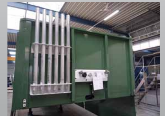
Zertifizierte Stirnwand aus Stahl mit Rungenablage
