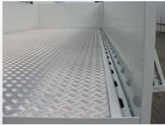
Außenrahmen mit variablen Zurrmöglichkeiten
