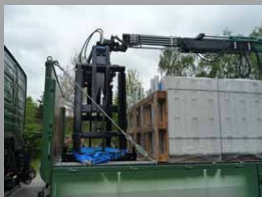
Ablageposition der Steinzange hinter Stirnwand
