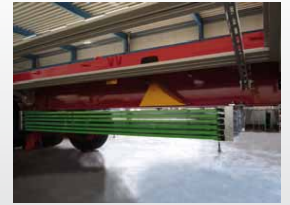
Geschraubtes Bordwandablagegestell, verzinkt
