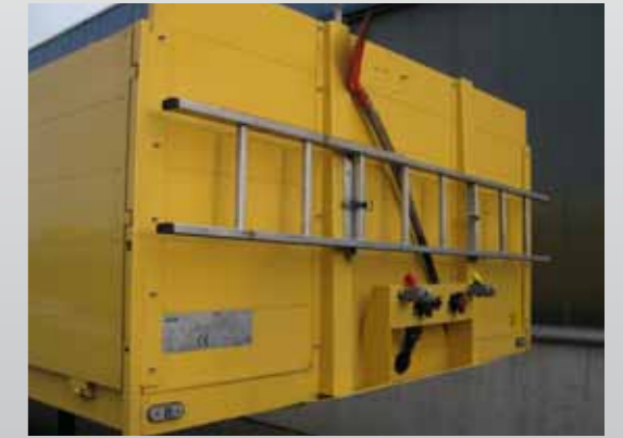
Leichte Stirnwand aus Aluminium
