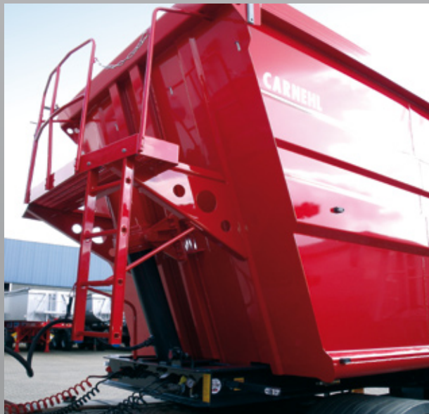
Sicherheitspodest an schräger Stirnwand
