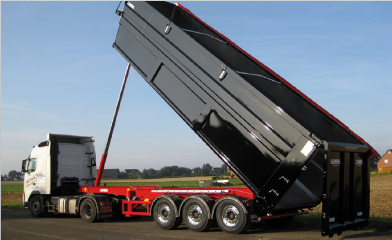
Alu-Großraummulde mit profiliertem Seitenwand
