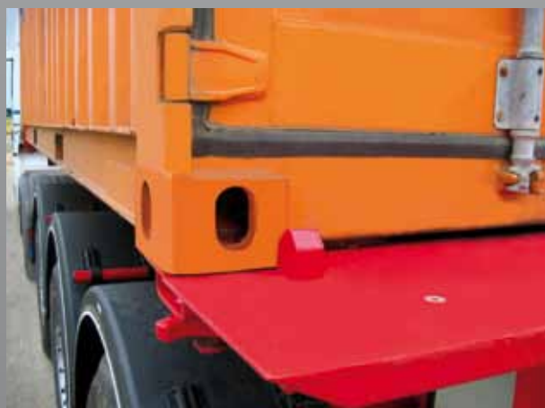
Schüttblech mit integrierter Containersicherung
