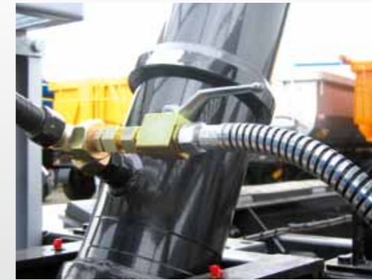
Abschaltventil für hydr. Rückwand
