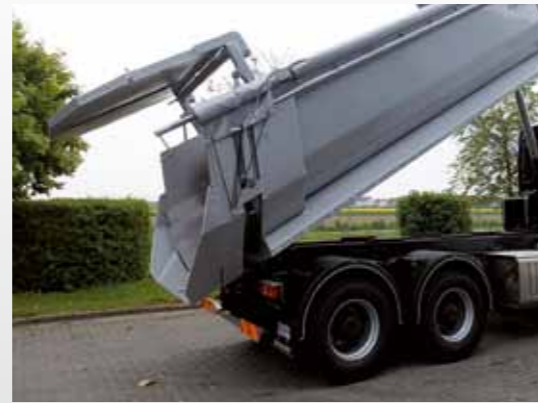
Hydr. Rückwand mit großer Durchlaßöffnung
