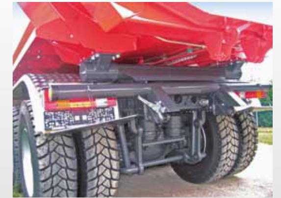
Klappbarer Unterfahrerschutz f. Fertigerinsatz
