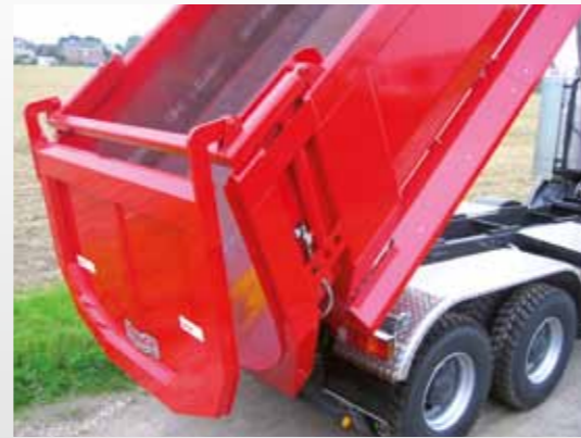
Abschaltbare hydr. Rückwand als Pendelklappe
