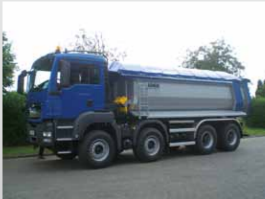
Hydr. Rückwand mit großer Durchlaßöffnung
