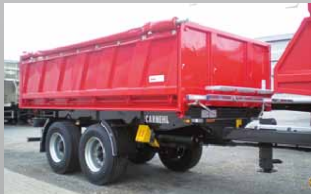
...mit Stahlbordwänden in Jetbauweise
