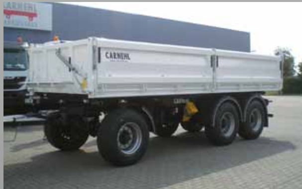
3-achsig, mit Stahlbordwänden
